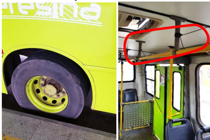
Figura 11: Problemas de manutenção – pneu (esq.) e cordão de acionamento de parada (dir.)
