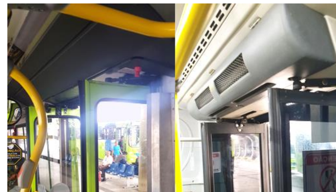
Figura 13: Veículos sem e com cortina de ar junto às portas
